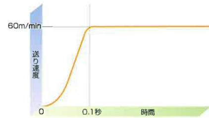
位置決め時間の短縮は加工時間の短縮につながります。FJV-200UHSではナット部のリターンチューブを改良した高速仕様の2条ボールネジと低慣性サーボモータの採用によって高速化を行いました。また最高速度に到達する加速度を1.0Gにして非切削時間の削減をしました。
