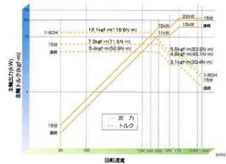
モータは巻き線切り換え方式を採用し、出力-トルク特性として従来機と同様の高速域での高出力特性に加えて低速域でのトルクアップをはかり、幅広い種類の素材の加工能力を実現しました。
